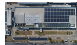
タイ日清のナワナコン工場に設置された太陽光パネル
