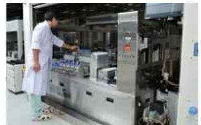
置）は、食品から農薬を抽出する煩雑な操作を世界で初めて自動化した装置で、人による作業の3倍以上の処理能力があり、公定法と同等以上の精度を有しています。2016年度には動物用医薬品やその他危害物質にも対応可能な自動前処理装置FASVED※2を新たに開発、運用開始したことにより、1日の処理件数が2倍に増えました。
