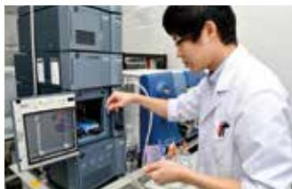
フ・タンデム型質量分析計（LC/MS/MS）を使用し、高感度な分析を実現しています。
