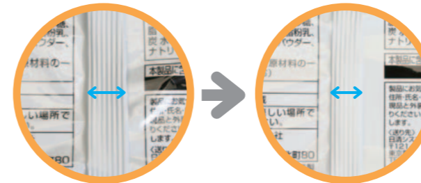
「チョコフレーク」のヒートシール部分のフィルム幅を5mm削減
